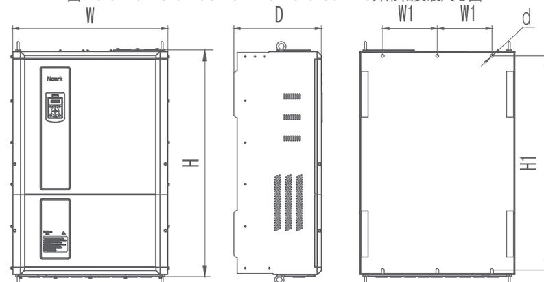
图2-8-4 Ex9VF3-0750CT43 ~ Ex9VF3-3150VT43外形和安装尺寸图
