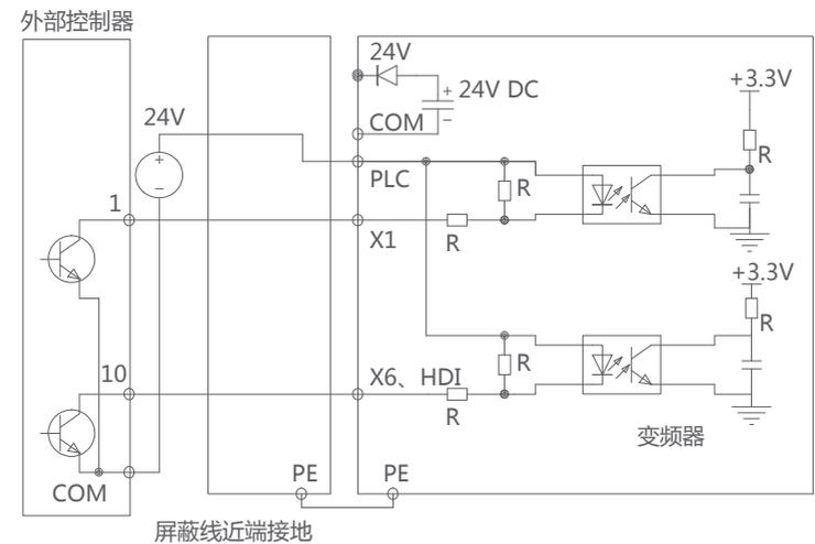
图3-8-4 使用外部电源的源极连接方式
