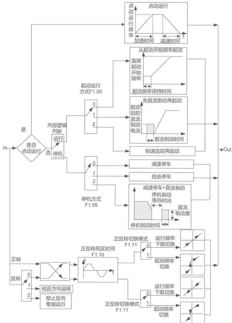
图7-5-1变频器控制方式逻辑图
