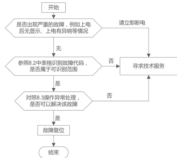
图8-4-1故障诊断流程图
