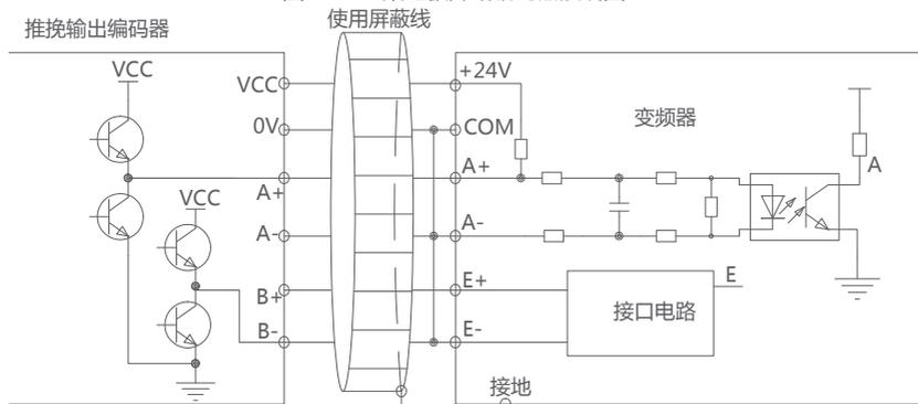
图3-8-11 推挽输出编码器接线图
