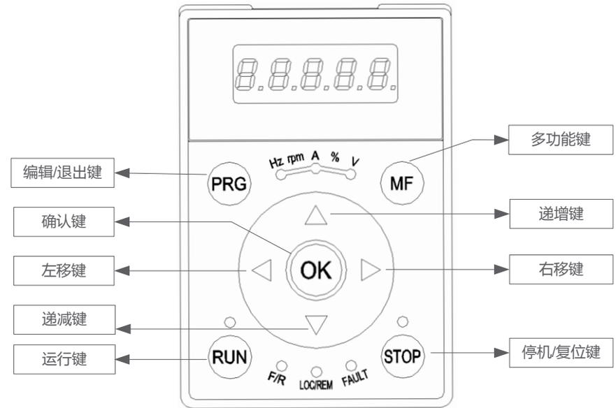
图4-2-1 LED操作面板示意图
