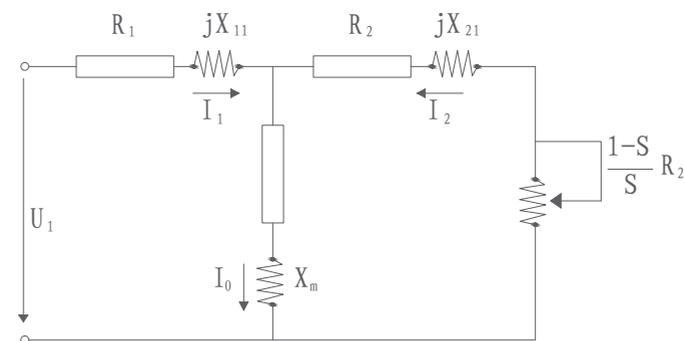
图7-6-1异步电机稳态等效电路图
