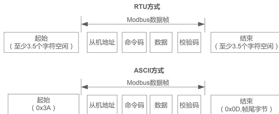
图A-5-1 Modbus协议格式
