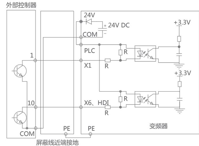
图3-8-3 使用变频器内部+24V电源的源极连接方式
