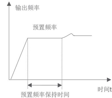
图7-14-4 闭环预置频率运行示意图
