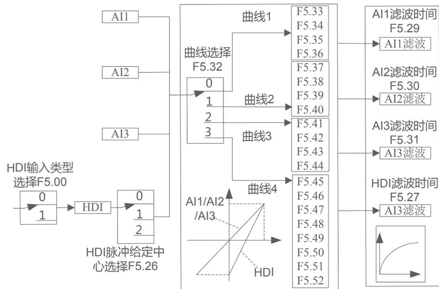
图7-11-1 模拟量输入端子逻辑图
