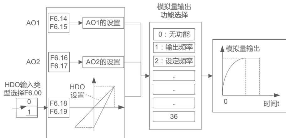
图7-12-1 模拟量输出端子逻辑图
