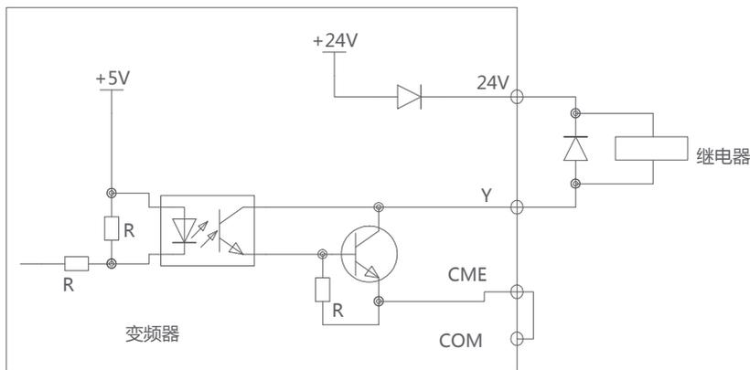
图3-8-5 多功能输出端子接线方式1
