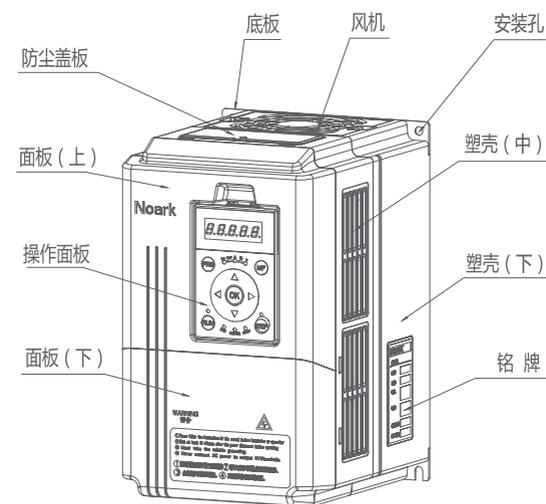
图2-6-1 Ex9VF3-0015CT43 ~ Ex9VF3-0110VT43外形部件图
