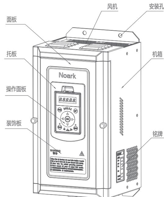
图2-6-2 Ex9VF3-0110CT43 ~ Ex9VF3-0220VT43外形部件图
