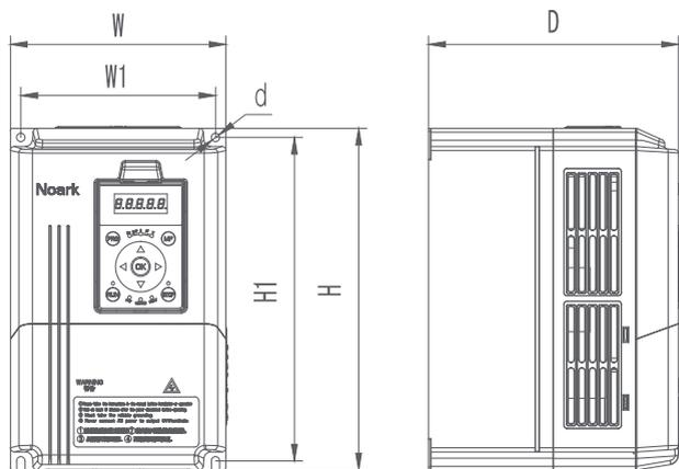
图2-8-1 Ex9VF3-0015CT43 ~ Ex9VF3-0110VT43外形和安装尺寸图
