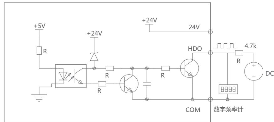
图3-8-8 输出端子HDO连接方式2
