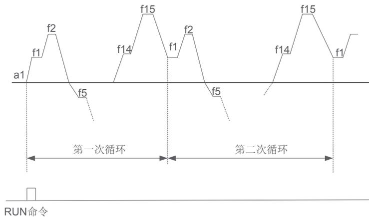
图7-16-4 PLC连续循环方式
