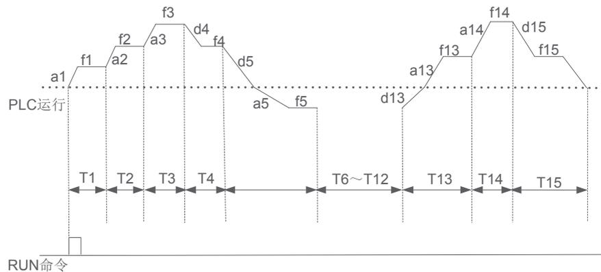
图7-16-2 PLC单循环后停机方式
