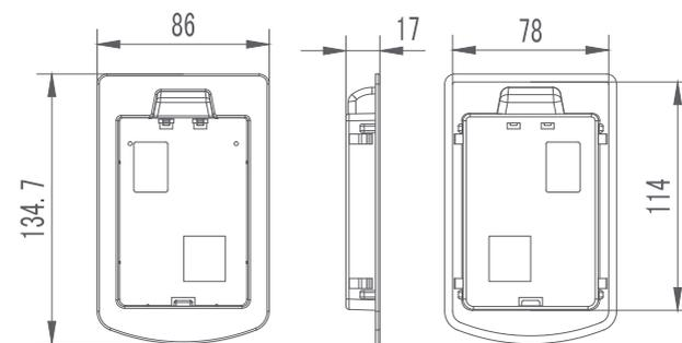
图2-9-2 托板的外形尺寸
