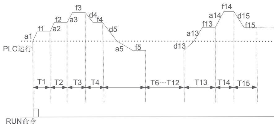
图7-16-3 PLC单循环后保持方式
