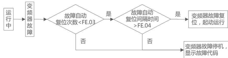
图7-5-3变频器故障再启动逻辑图
