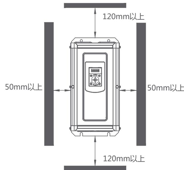
图3-3-1 变频器安装示意图
