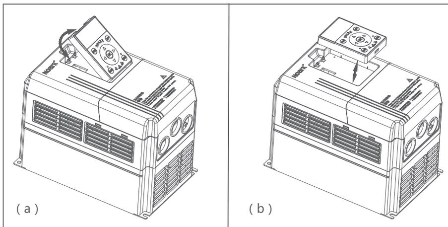
图3-4-1 塑壳操作面板的拆卸和安装
