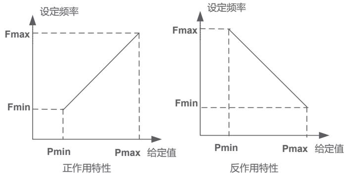
图7-11-2模拟输出频率特性曲线
