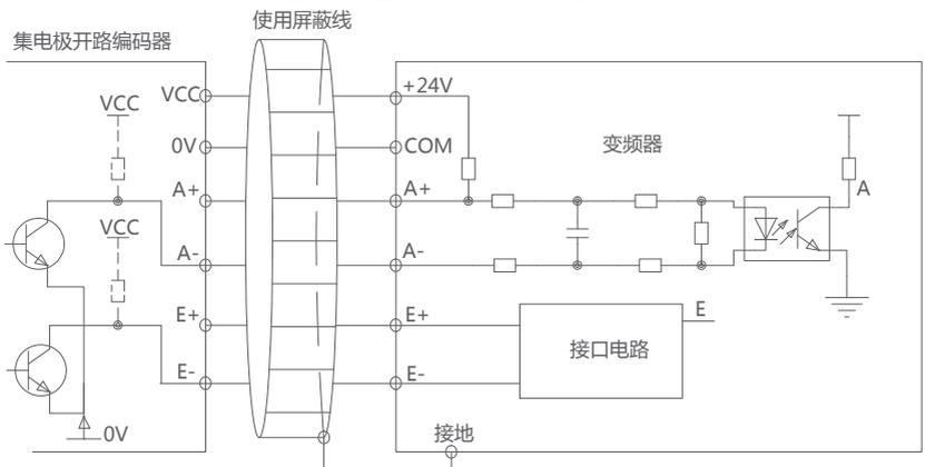
图3-8-10 集电极开路编码器接线图
