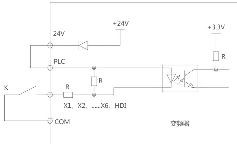
图3-8-1 使用内部24V电源的连线方式
