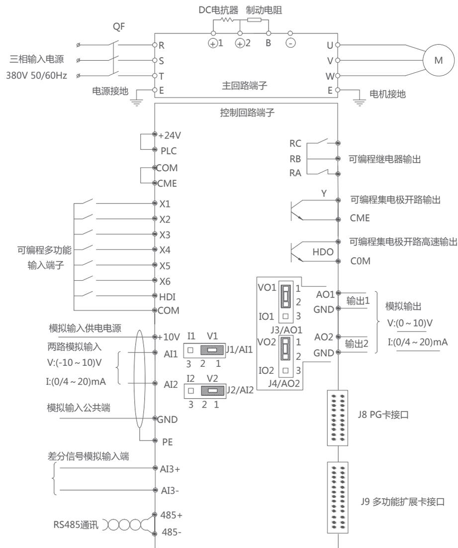
图3-6-1 控制端子的接线图
