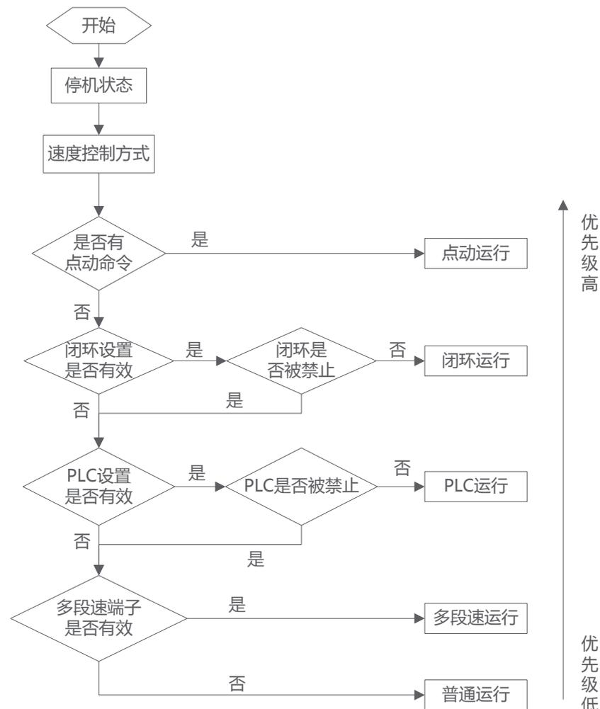
图7-3-1速度控制模式下运行方式优先级
