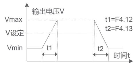
图7-8-4 V/F分离曲线输出电压的上下限值
