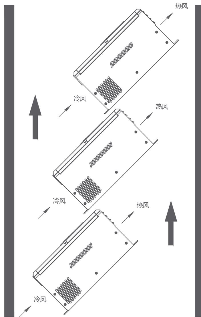
图3-3-3 多台变频器倾斜安装
