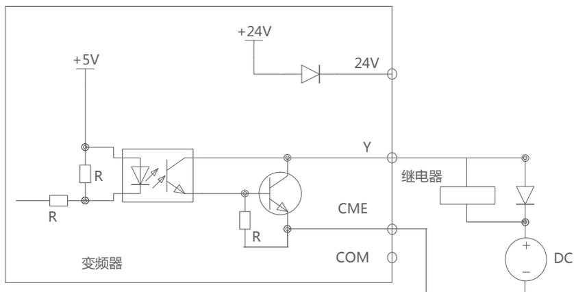
图3-8-6 多功能输出端子接线方式2
