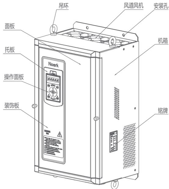
图2-6-3 Ex9VF3-0220CT43 ~ Ex9VF3-0750VT43外形部件图
