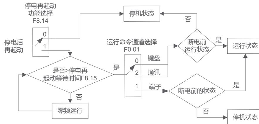
图7-5-2变频器停电再启动逻辑图
