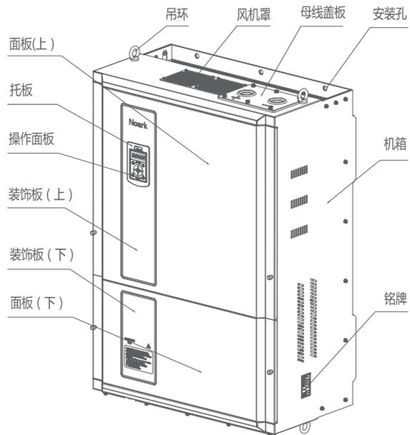
图2-6-4 Ex9VF3-0750CT43 ~ Ex9VF3-3150VT43外形部件图
