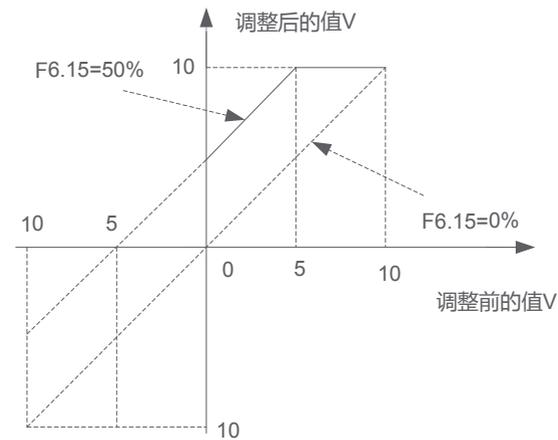
图7-12-3模拟输出与零偏关系曲线
