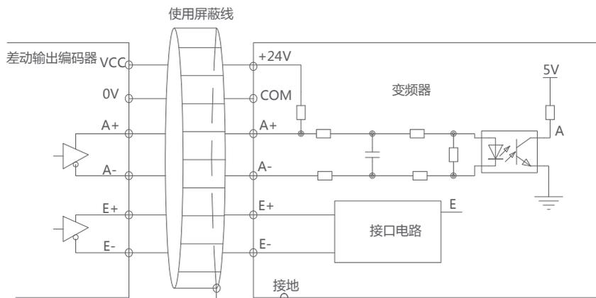
图3-8-9 差动输出编码器接线图
