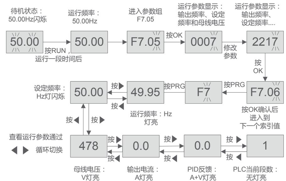
图4-3-7 监控运行状态参数操作示例
