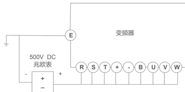
图9-2-1主回路绝缘电阻测试
