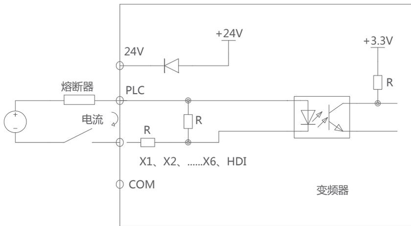
图3-8-2 使用外部电源的连线方式
