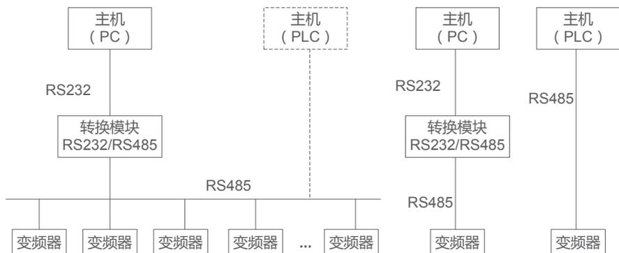
图A-2-1变频器组网方式示意图
