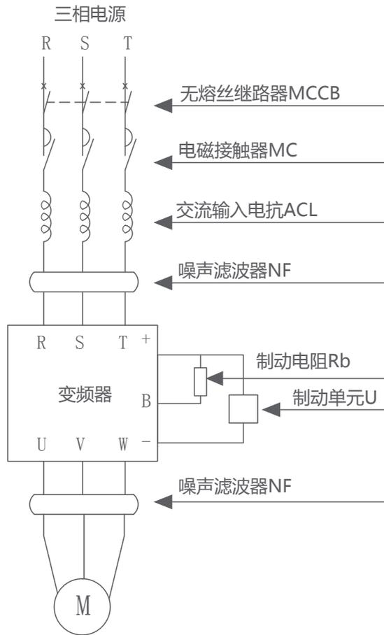
图B-2-1 外围选件连接图
