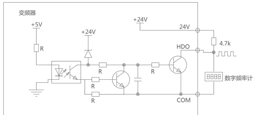
图3-8-7 输出端子HDO连接方式1
