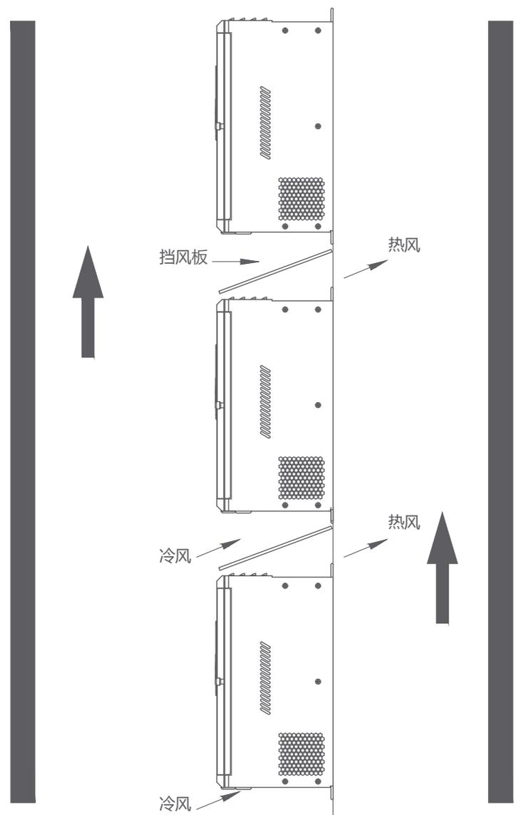
图3-3-2 多台变频器垂直安装
