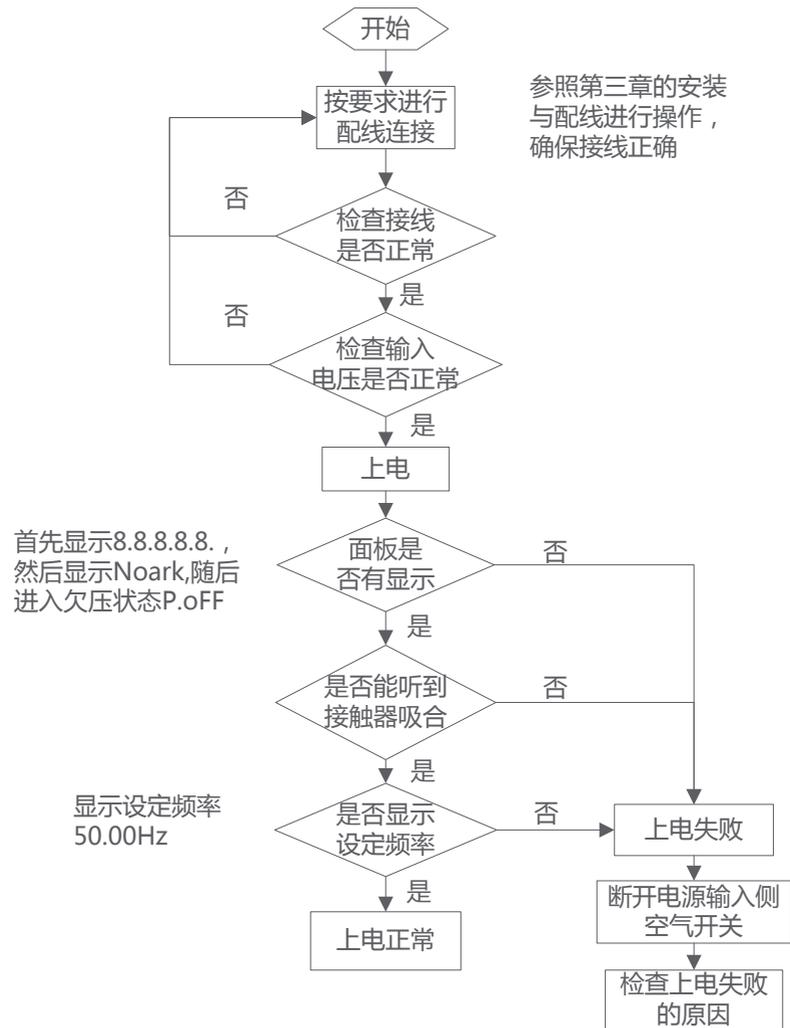
图7-2-1 变频器上电操作流程
